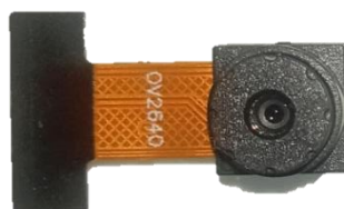
Gambar 2.4 Modul OV2640 (Sumber: Dokumen Pribadi)
