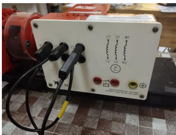
Gambar 3.3 Motor Induksi 3 Fasa Tipe 731404 Class 0.1.
