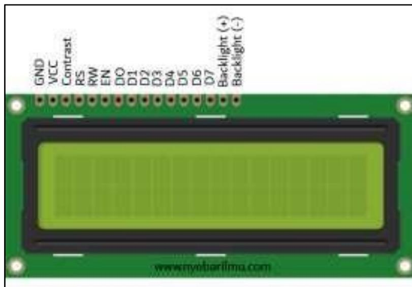
**Gambar 2. 7** LCD 20x4 (Nirwan dan Ms, 2020).
