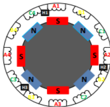
Gambar 2. 1 Konstruksi Motor BLDC
