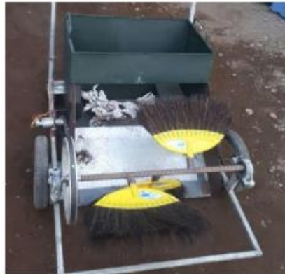
Gambar 2.2. Alat Penyapu jalan otomatis (Saputra, 2020)
