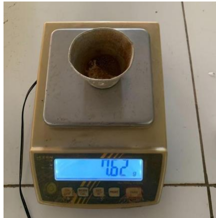
Gambar 29. Menimbang pan + tanah kering.
