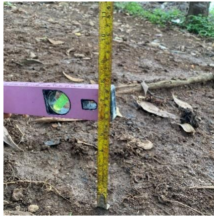
Gambar 23. Mengukur kemiringan lereng.
