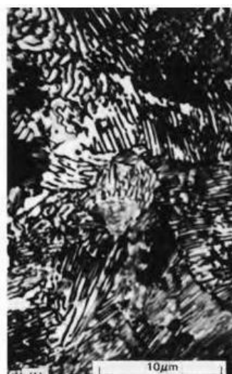
Gambar 6. Struktur Mikro Perlit Halus dengan pembesaran 3000x (Callister, 2007)
