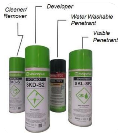
Gambar 7. Aerosol dan Pelarut Untuk Uji Liquid Penetrant
