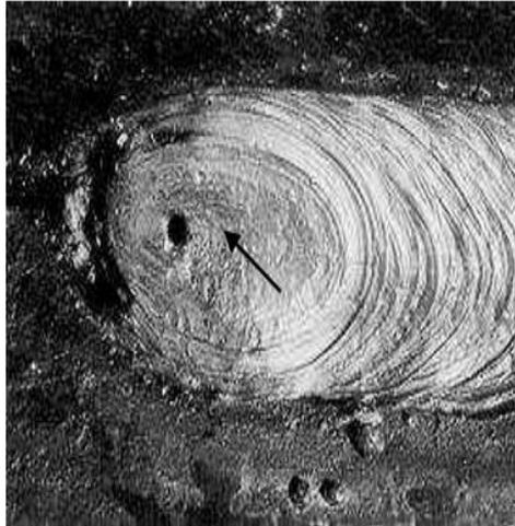
Gambar 19. Cacat Porositas
