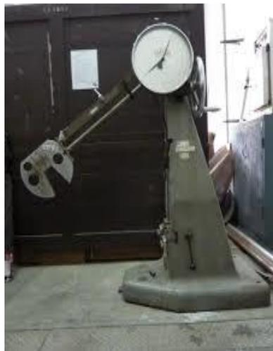
Gambar 25. Mesin Uji Impak
