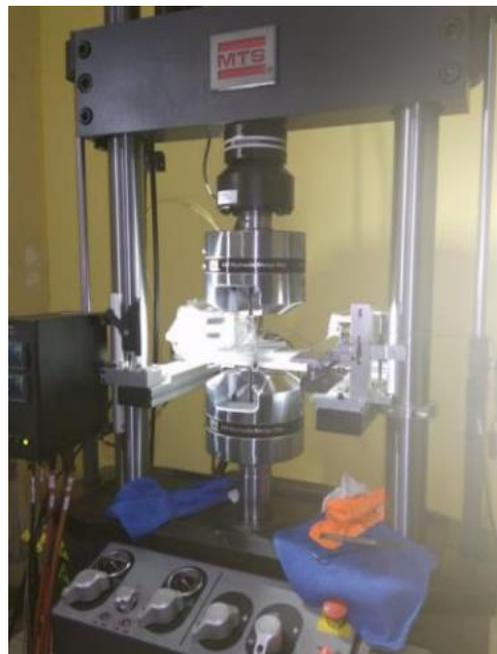
Gambar 24. Mesin Uji Tarik
