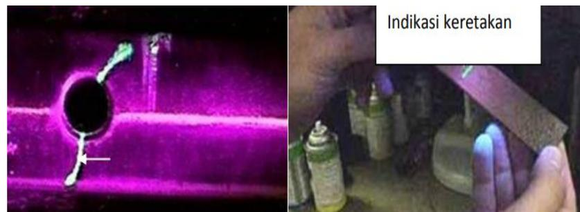
Gambar 13. Pengujian Penetrant
