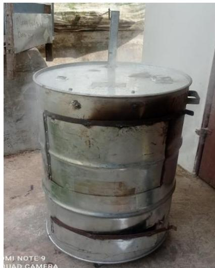
Gambar 2. Alat Pengasap Ikan Tipe Drum
