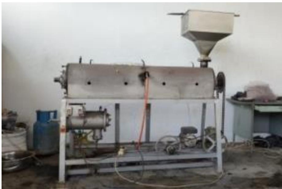
**Gambar 3.1.** Reaktor Torefaksi Kontinu Tipe Tubular dengan Sistem pemanas *Oil Jacket* dari LPG
