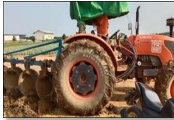
Gambar 6. Traktor *diskplow* untuk menghancurkan tanah.
