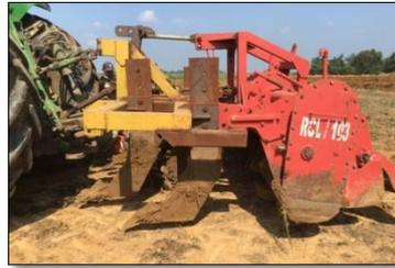
Gambar 4. Traktor *rotary tiller* untuk mencampurkan serasah tanaman hasil *chopping* dengan kompos.
