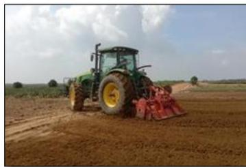
Gambar 7. Traktor FHK untuk memecah agregat tanah yang besar menjadi agregat yang lebih kecil.
