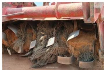
Gambar 3. Traktor *rotary lu* untuk memecah bongkahan tanah dan meratakannya.
