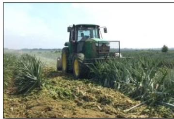
Gambar 2. Traktor *chopper* untuk mencabut, merobohkan, memotong dan mencacah tanaman nanas.
