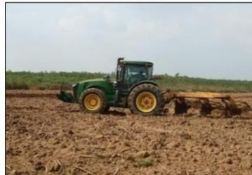
Gambar 5. Traktor *moalboard* untuk membalik dan membongkar tanah bagian atas serta membenamkan serasah tanaman ke tanah.
