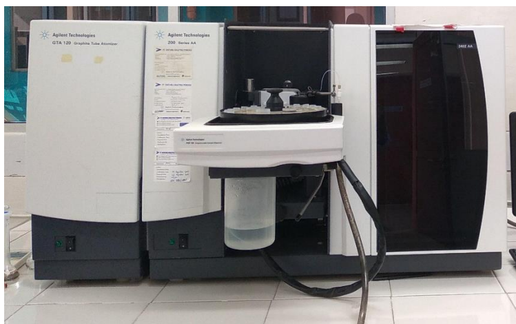
Gambar 5. Spektrofotometri serapan atom tungku grafit Agilent Technologies 200 Series AA GTA 120 tahun 2016.
