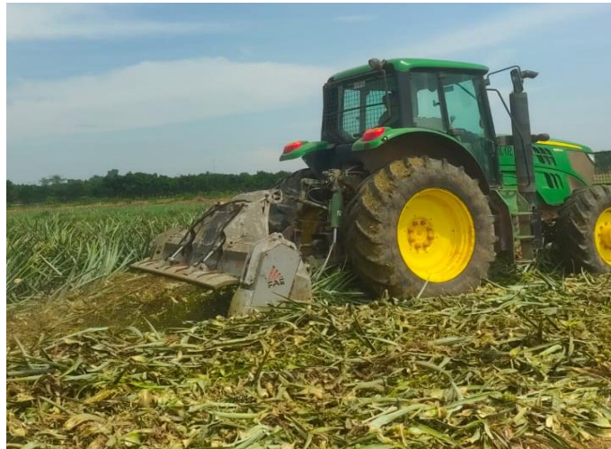
Gambar 2. Alat olah tanah chopping (pencacahan) tanaman nanas. (Sumber: Tim Penelitian GGP)
