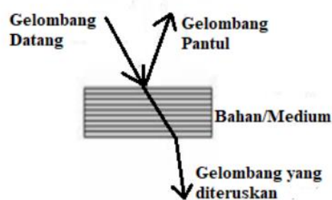
Gambar 2.3 Proses pemantulan, penerusan gelombang Infrared .
