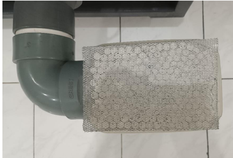
Gambar 3.18. Filter udara yang siap diuji
