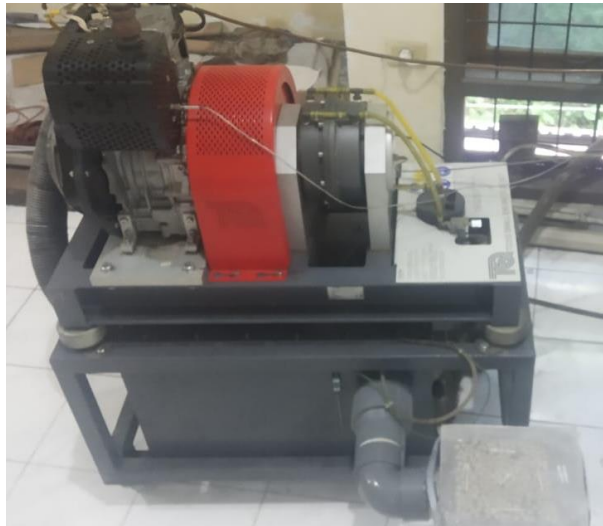
Gambar 3.19. Filter bentonit yang terpasang pada mesin uji
