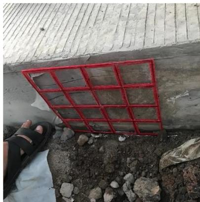
Gambar 3.14 *Frame uji hammer*
