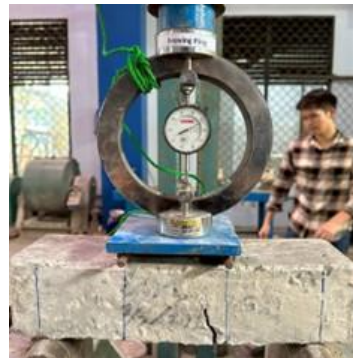
Gambar 8. Pengujian kuat lentur beton.
