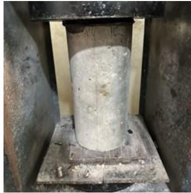
Gambar 6. Pengujian kuat tekan pada beton
