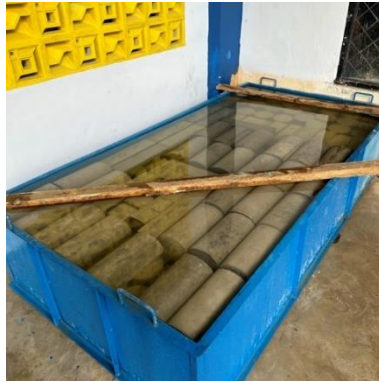
Gambar 5. Proses perendaman benda uji.
