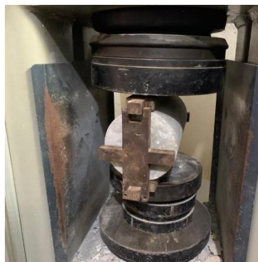
Gambar 7. Pengujian kuat tarik belah pada beton
