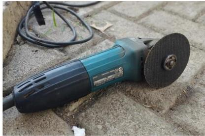
Gambar 3.2 Mesin grinda
