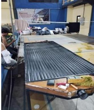
Gambar 3.55 Pemasangan plat pada meja kolektor
