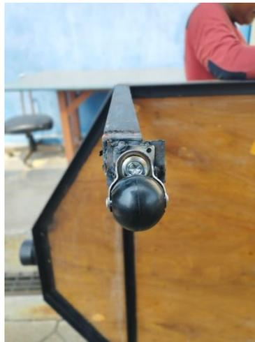
Gambar 3.19 Pemasangan roda
