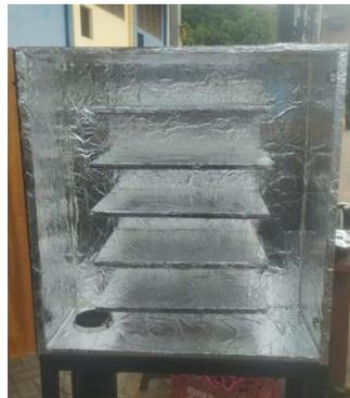
Gambar 3.9 Aluminium foil pada ruang pengering tipe rak
