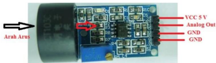
Gambar 2.5 Konfigurasi Pin – Pin Sensor ZMCT103C (Jumrianto, 2020)
