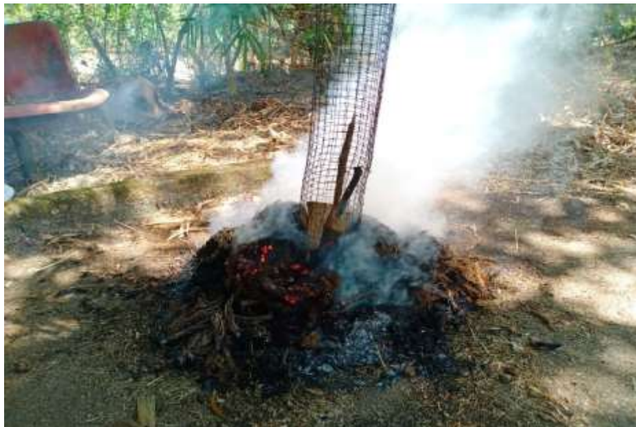
Gambar 4. Pembuatan Biochar menggunakan Cerobong dari kawat kasa dalam pembuatan biochar tandan kosong kelapa sawit.
