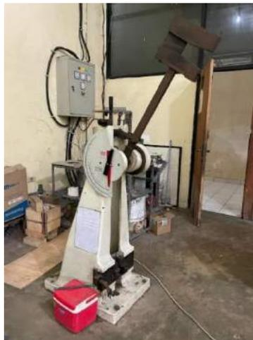
Gambar 3. 8 Alat Uji Impak
