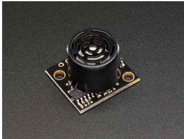
Gambar 6. Sensor Ultrasonik Maxbotix MaxSonar EZ1
