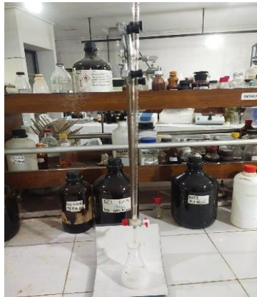
Gambar 5. Pengukuran total asam
