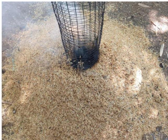
Gambar 4. Metode tradisional dalam pembuatan *biochar* sekam padi.
