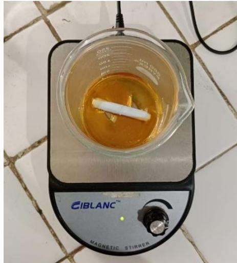
Gambar 7. Pengadukan sampel menggunakan *magnetic stirrer*
