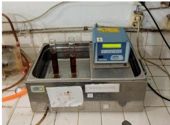
Gambar 6. Pemanasan sampel menggunakan *water bath*
