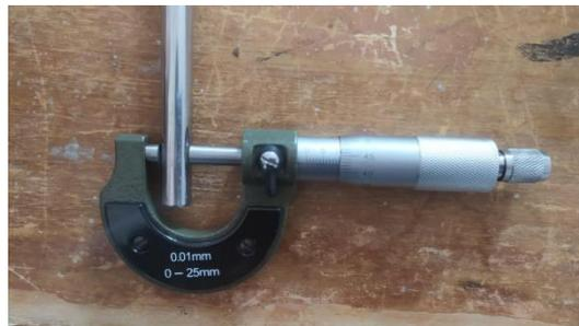
**Gambar 11.** Contoh Mengukur Ketebalan Benda dengan Mikrometer Sekrup
