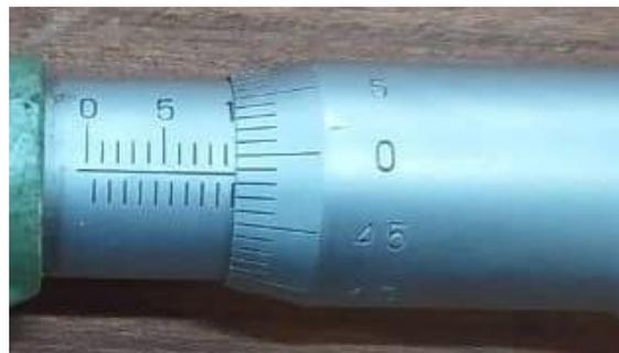
**Gambar 12.** Contoh Soal Mengukur Menggunakan Mikrometer Sekrup
