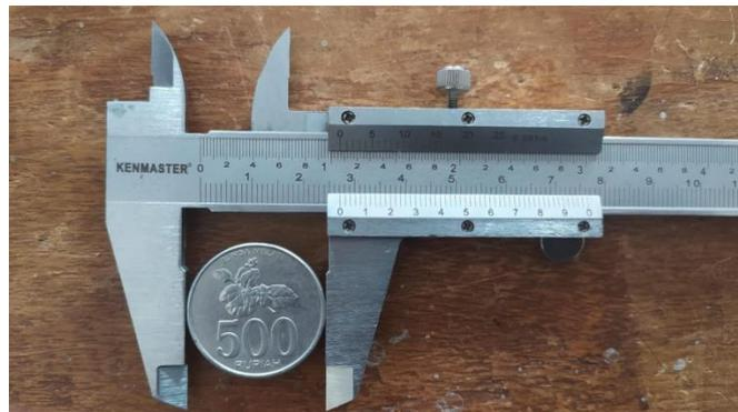
**Gambar 8.** Contoh Mengukur Diameter Luar Benda dengan Jangka Sorong
