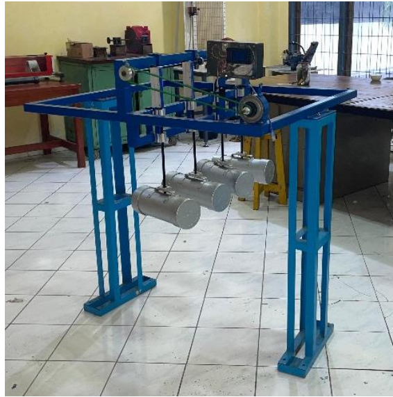
Gambar 3.17. Model pembangkit listrik tenaga gelombang laut tipe gear (rack and pinion) searah
