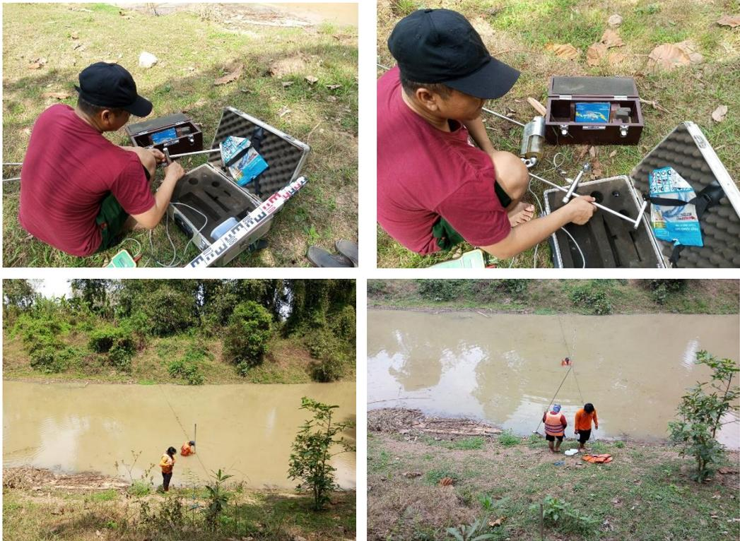
Menurut (Hariadi *et al.*, 2017) bentuk dari *sediment trap* berbentuk silinder berupa pipa paralon dengan diameter 10 cm dan tinggi 50 cm. Tahapan pengambilan dan pengolahan laju sedimentasi yaitu alat *sediment trap* diletakkan di dasar perairan.
