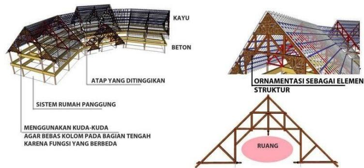
**Gambar 2.13.** Sistem struktur atap
