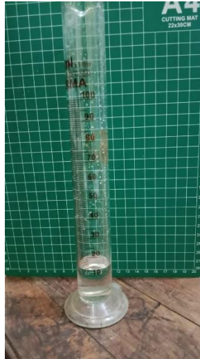
Gambar 18. Penuangan larutan BF kedalam gelas ukur 100ml
