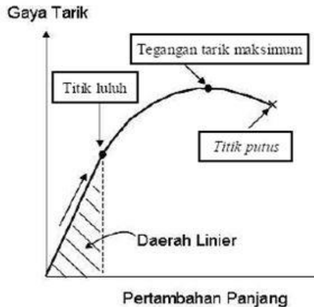
Gambar 2.1 Diagram Uji Tarik (Salindeho, 2013).
