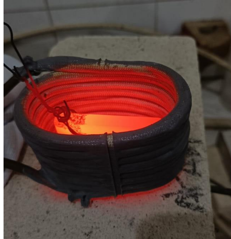
Gambar 3.6 Proses Pemanasan Spesimen sebelum dilakukan Austempering dengan Larutan Garam
