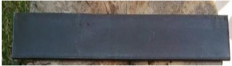
Gambar 3.3 Baja JIS-SUP9 sebelum proses mekanik
