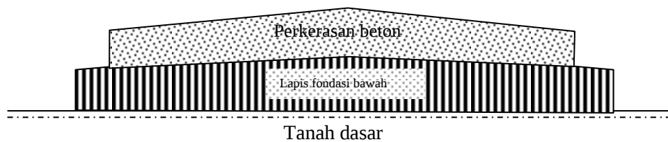
Gambar 2. 9 Komponen lapis perkerasan kaku.
