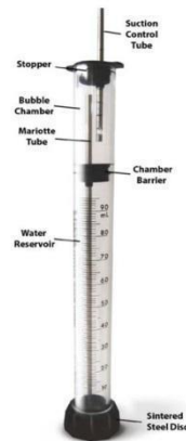
Gambar 5. Alat minidisk infiltrometer Keterangan : Alat mengukur ifiltrasi tanah
