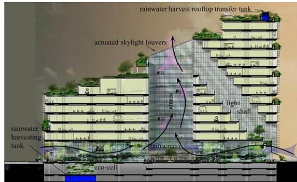
*Gambar 2. 55 Aliran Udara Bangunan Solaris Fusionopolis*
