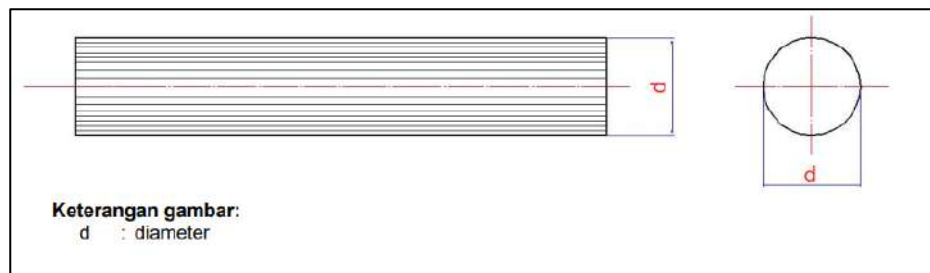
Gambar 3. Baja Tulangan Beton Polos (BjTP)
