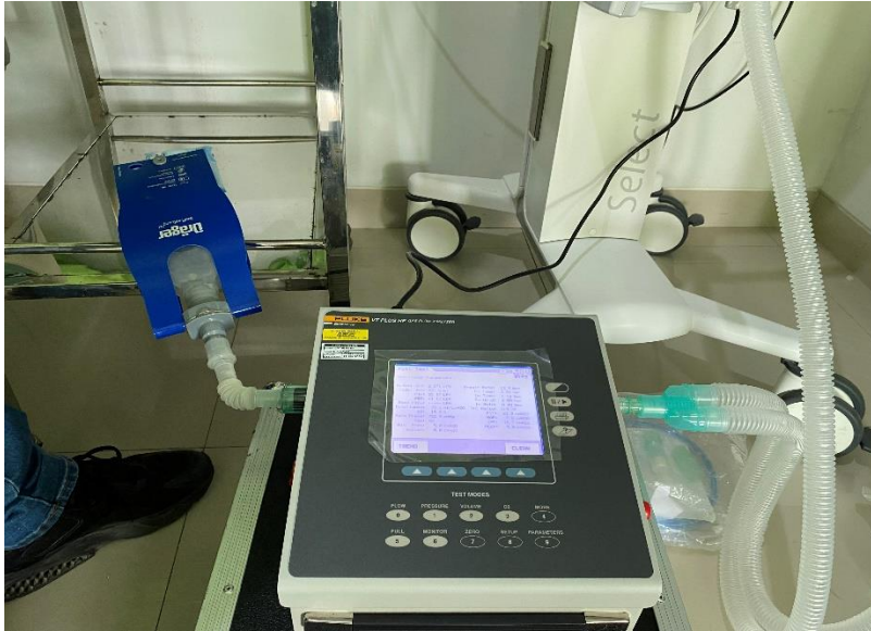
Gambar 3.9 prosedur pengukuran kalibrasi ventilator pihak ke dua
