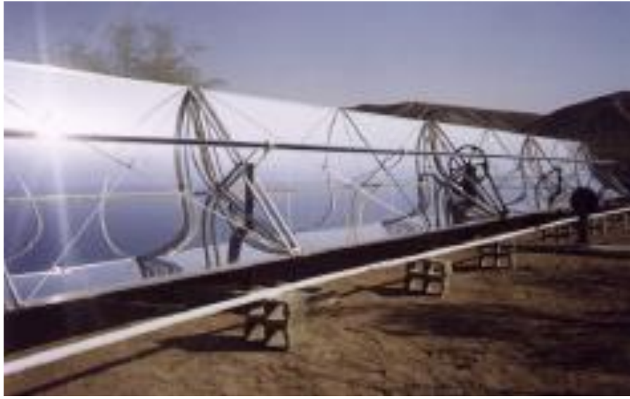
Gambar 2.3 Kolektor Surya Parabola
