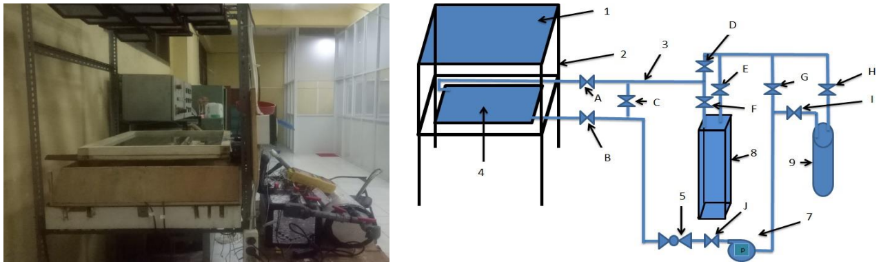
Gambar 3.11. Skema Pengujian PCM pada HE
