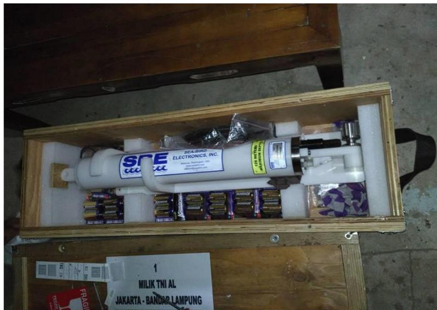
Gambar 5. Foto alat ukur gelombang SBE 26 ( Sea Bird Electronics ). (Sumber: Dokumentasi, 2017)
