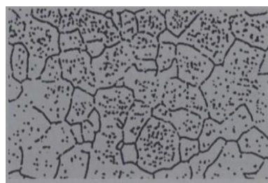
Gambar 2. 2 Struktur mikro ferrit (Winardi., dkk. 2020).
