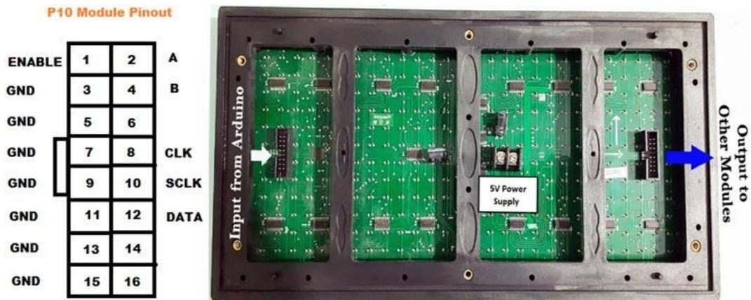
**Gambar 2.13** Pin Out Modul DMD P10 (Das, 2020).
