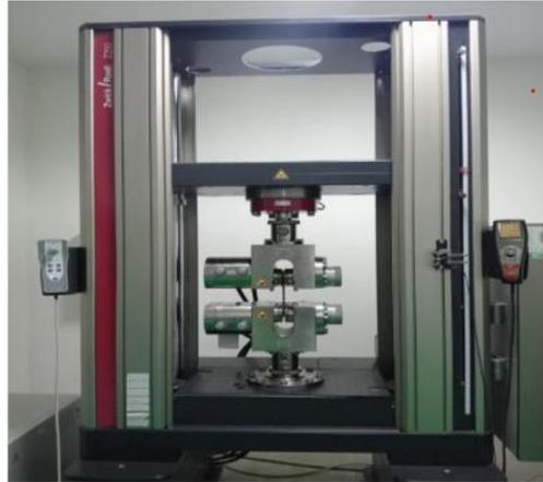
Gambar 3.4 Alat Uji Tarik Mesin *Zwick Roell 250 KN*
