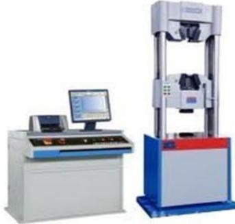
Gambar 2.14. Mesin uji tarik
