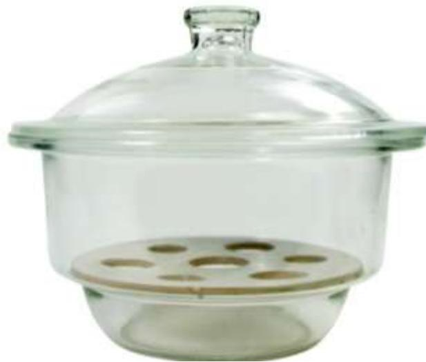
Gambar 5. Pengujian sampel tanah agregat dengan metode tekanan uap.
