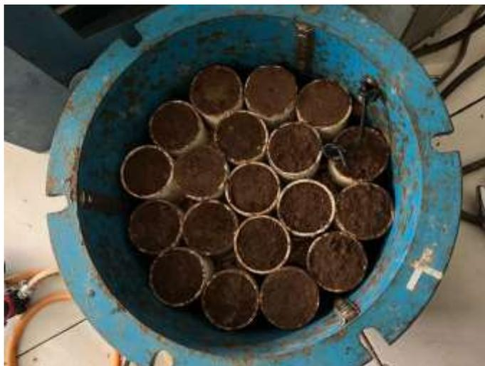
Gambar 4. Pengujian sampel tanah ring dengan metode *Pressure Plate Apparatus*.
