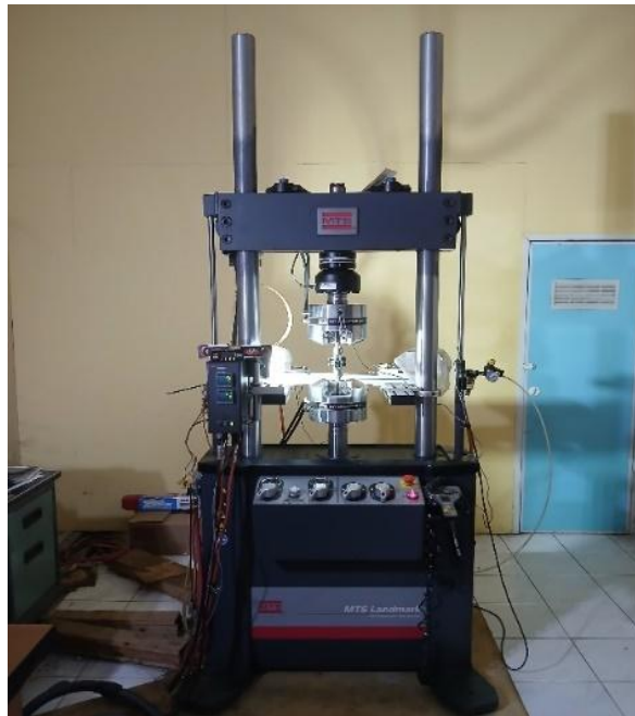
Gambar 3.4. MTS Landmark 100 kN
