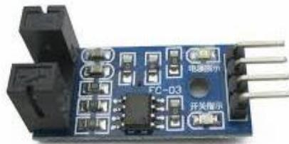
Gambar 2. 13 Sensor Kecepatan
