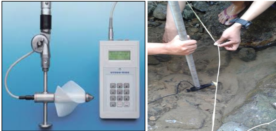
Gambar 10. Current meter dan Pengukuran Kedalaman, Kecepatan Aliran
