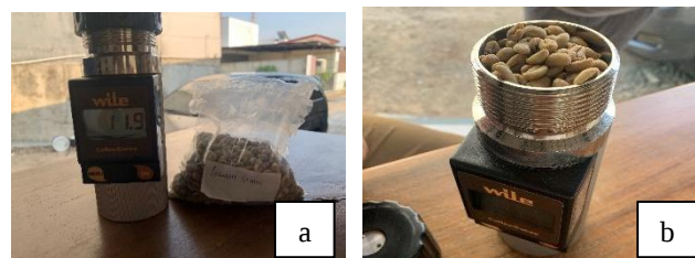
Gambar 10. Pengecekan kadar air biji kopi: (a) kadar air biji kopi klon Srintil dan (b) alat kadar air menggunakan alat moisture tester .
