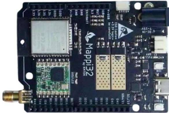
Gambar 2. 2. Mikrokontroler Mappi 32
