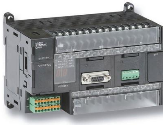
Gambar 2.13. PLC OMRON CP1H-XA40DR-A [23].
