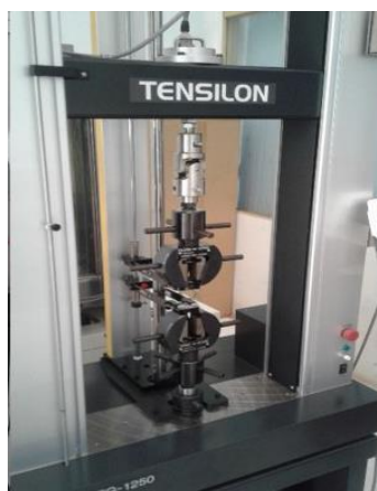
Gambar 3. 14 Pengujian Tarik Komposit ( https://elsa.brin.go.id )
